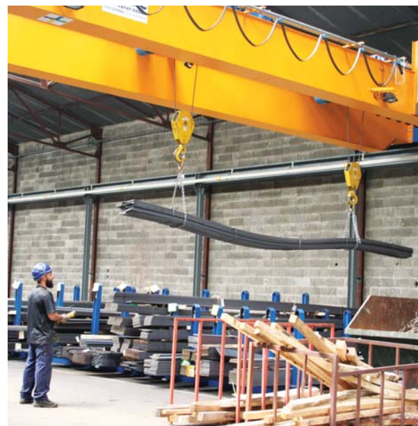
Un pont de levage de poutrelles
